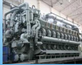
陕西柴油机重工有限公司承制“华龙一号”首台套1E级柴油发电机组设备顺利通过验收并发往现场。该项目分4台套应急机组，一台套备用机组。项目采用12PC2-6B机型，设计功率8000Kw。
