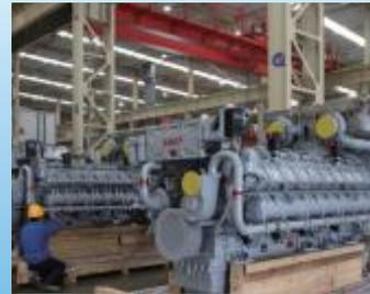
中国船舶重工集团柴油机有限公司大柴公司制造的首台带低压选择性催化还原（LP-SCR）的5G60ME-C MK9.5智能型绿色环保主机成功交验。该主机额定功率为8304千瓦、11298马力，可满足国际海事组织Tier III 排放标准。
